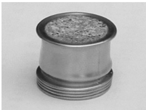
图 7 泡沫铝层合钢管压缩后的照片
